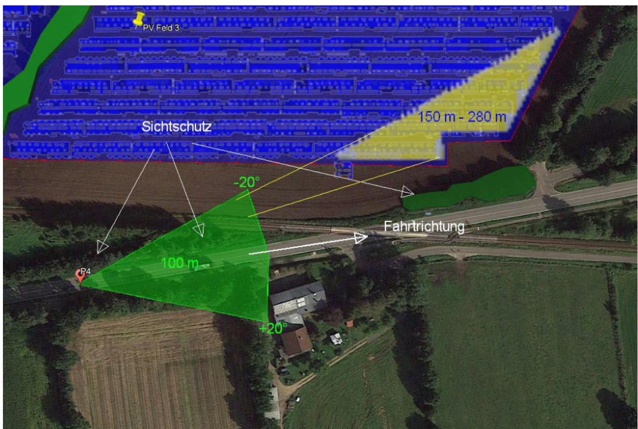
Bild 4.4.1: Simulation am Messpunkt P4 (Quelle: Google Earth / SolPEG)
